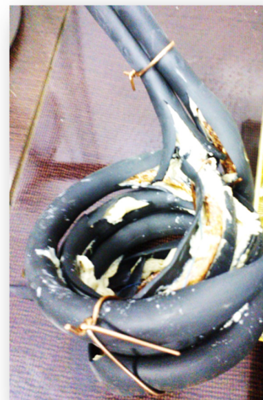
Воздействие масла и бензина на кабель с обычной оболочкой и изоляцией (т.е. не маслобензостойкой)
