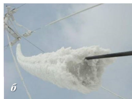
Рисунок 2 а,б Характерное обледенение проводов с круглой проволокой
